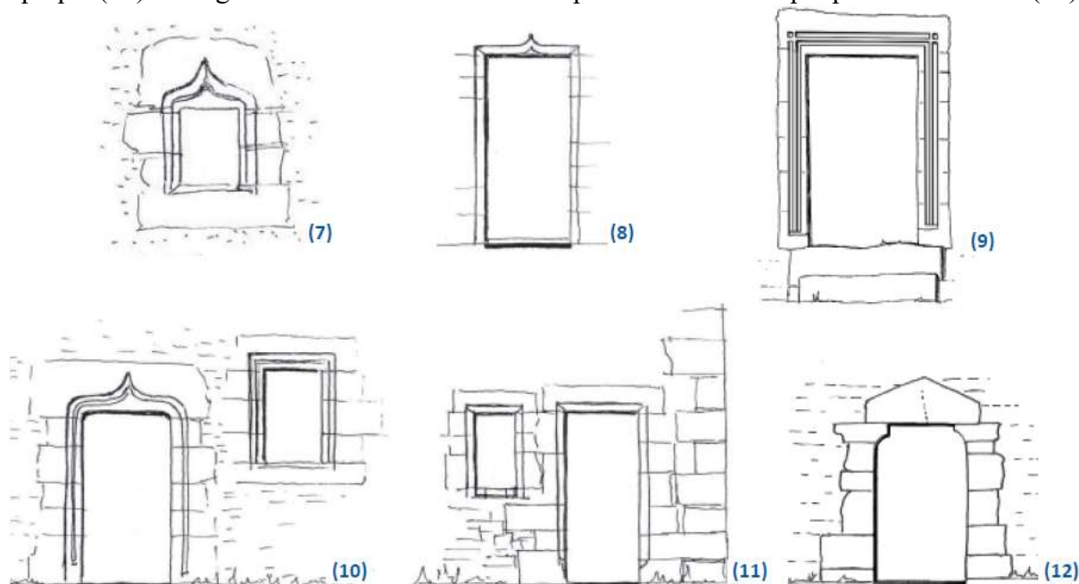
Illustrations 7 à 12 : Illustrations sans valeur réglementaire. Les éléments décoratifs sont rares et concentrés sur les encadrements des baies.
